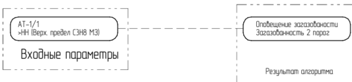
Рисунок 24 – Схема запуска оповещения загазованности «Загазованность 2 порог»
