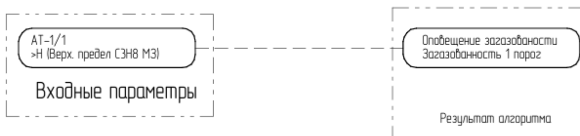
Рисунок 22 – Схема запуска оповещения загазованности «Загазованность 1 порог»
