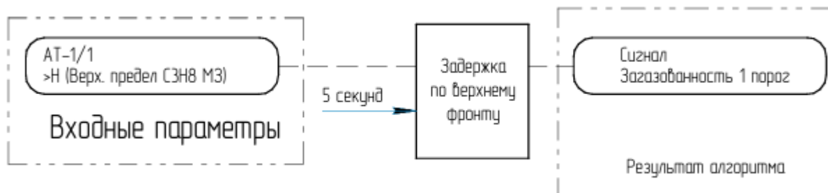
Рисунок 21 – Схема формирования сигнала «Загазованность 1 порог»
