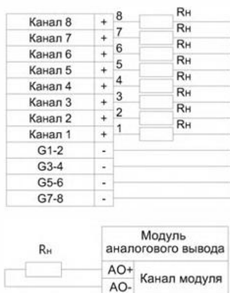
Рисунок 12 – Подключение модуля аналогового вывода АБАК ПЛК
