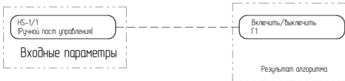
Рисунок 25 – Схема формирования сигнала включения/выключения горелки по сигналу с ручного поста
